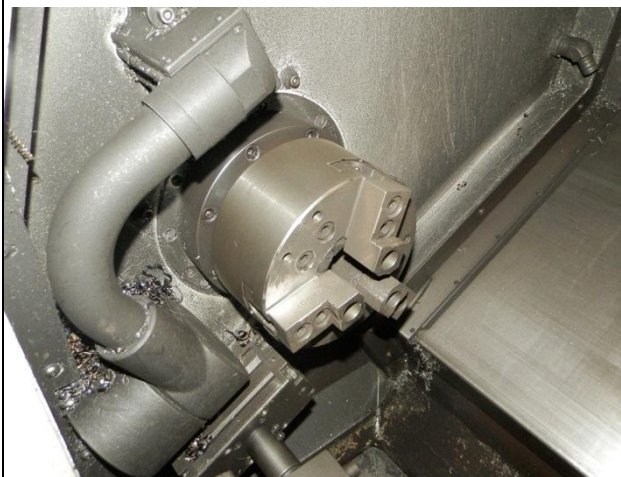
Трехкулачковый патрон с гидравлическим зажимом
